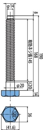
締付可能寸法 最小12mm～最大95mm
